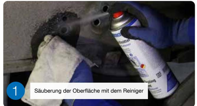
1 Säuberung der Oberfläche mit dem Reiniger
