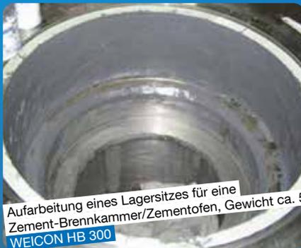
Aufarbeitung eines Lagersitzes für eine Zement-Brennkammer/Zementofen, Gewicht ca. 500 t
