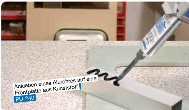
Ankleben eines Alurohres auf eine Frontplatte aus Kunststoff
