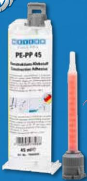
WEICON Easy-Mix PE-PP 45 gleicht durch seine etwas höhere Viskosität problemlos Klebefugen bis 1 mm aus und gewährleistet durch die im Klebstoff enthaltenen Füllstoffe (Glaskugeln) eine Klebefuge von mindestens 0,20 mm.
