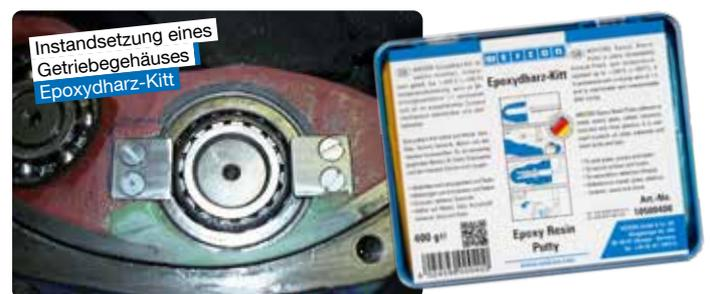
Instandsetzung eines Getriebegehäuses
