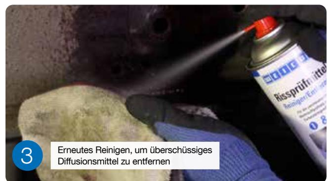
3 Erneutes Reinigen, um überschüssiges Diffusionsmittel zu entfernen
