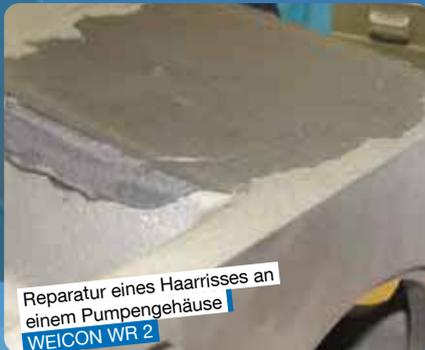
Reparatur eines Haarrisses an einem Pumpengehäuse
